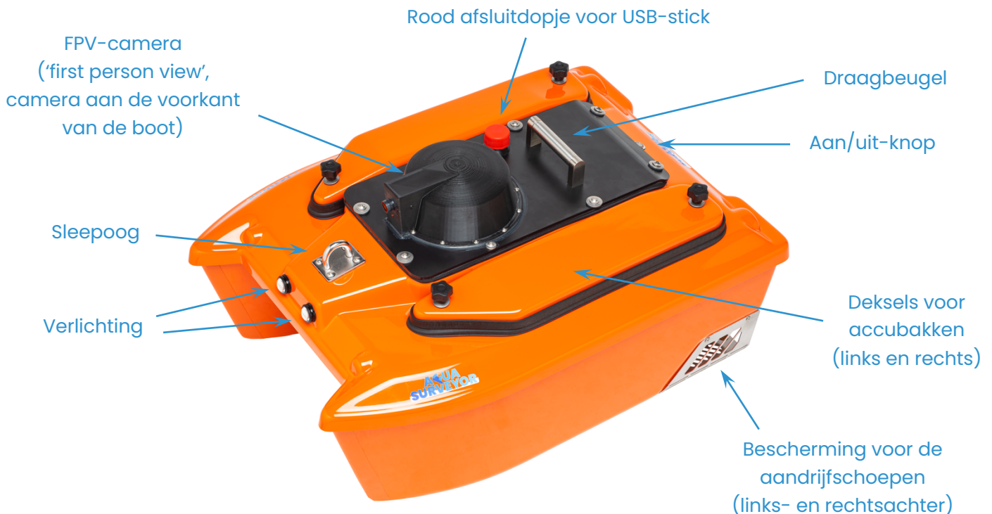
Afbeelding 5.2: Onderdelen van de AquaSurveyor Mini
